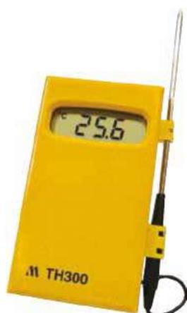
Los científicos y técnicos de laboratorio dependen de la exactitud de sus termómetros cuando realizan las rutinas de mediciones. Esta unidad de tamaño de la palma es un INSTRUMENTO DE ALTA PRECISIÓN que está destinado a hacer que los termómetros de vidrio sean obsoletos, está equipado con una sonda de propósito general de acero inoxidable y un cable de 1 metro para hacer de la lectura a distancia una tarea sencilla.
