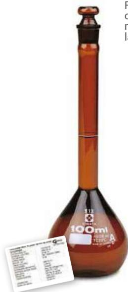
Fabricado en VIDRIO BOROSILICATO 3.3. De color ámbar para proteger los materiales sensibles a la luz con bajo contenido de elementos actínicos. Se emplea para medir un volumen determinado de líquido. La forma correcta de medir volúmenes con precisión es cuando el líquido llega hasta la marca. El cuello del balón es estrecho para aumentar la exactitud.
