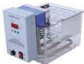
Útil para los puntos de fusión y ebullición alcanzando temperaturas cercanas a los 100oc, trabajando a presión atmosférica.
