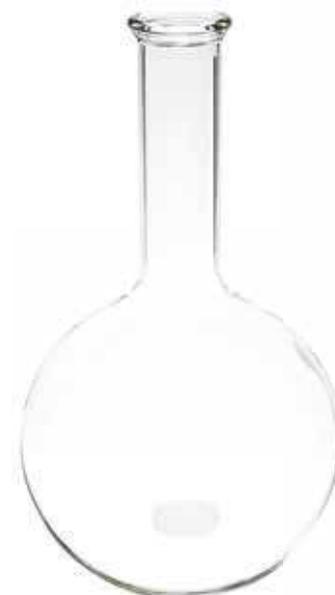
Fabricado en vidrio borosilicato 3.3. Base redonda con espesor de pared gruesa. DIN 12392 & USP Standard
