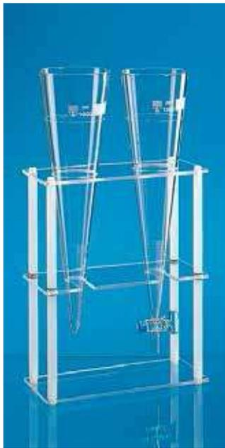
Fabricado en estireno acrilonitrilo (SAN) material totalmente transparente y con graduación permanente en relieve. Dispone de un tapón inferior de rosca que facilita su limpieza. Contenedor con forma de cono usado para medir el volumen de sólidos depositados en un volumen específico de agua.
