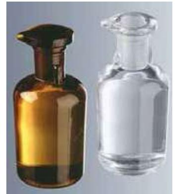
Fabricado en vidrio soda color ámbar que protege las sustancias químicas sensibles a la luz, pipeta en vidrio esmerilado y chupa de goma.
