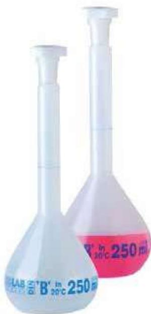
Fabricado en polimetilpenteno (PMP) transparente, Balón y Tapón, permite una fácil lectura, tapón cónico en polipropileno (PP) auto-clavable. Producto idóneo al contacto con alimentos. Se emplea para medir un volumen determinado de líquido.
