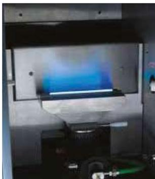
Equipo completamente controlado con auto alineamiento de ocho Lámparas hueco torreta. D2 y Auto Reversión corrección de fondo. Todos los flujos de gas se controlan automáticamente mediante AAWin-Pro Software. Tres quemadores están disponibles con el sistema. Todos los quemadores son datos codificados para una máxima seguridad. La Caja de gas está totalmente controlado a través AAWin-Pro Software.
