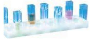
Fabricados en poliestileno (LDPE) para cerrar cubetas con boca de sección cuadrada (10 x 10 mm) Ideales para agitar eventualmente la muestra o como seguridad en caso de derrame accidental.
