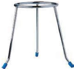
Es utilizado principalmente como una herramienta de sostén para la malla metálica con centro de cerámica, con un soporte circular, aro de fundición y patas de acero zincado.
