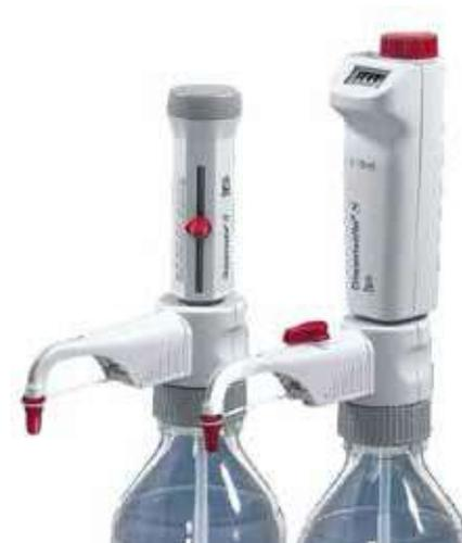
Un dispensador con un sistema de recirculación de reactivo para manual de dispensación directamente de la botella de reactivo. Disponible en seis volúmenes diferentes.
