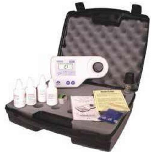
Instrumento para medir los parámetros más críticos y para asegurar; una buena calidad del agua, cloro libre. Este equipo proporciona una mayor resolución, mejor precisión y resultados inmediatos. El cloruro es un componente importante del agua y es extremadamente corrosivo en ambientes ácidos. Se requiere una estrecha vigilancia en aplicaciones tales como calderas y sistemas de refrigeración. Por esto se recomienda el FOTÓMETRO PARA CLORO MARTINI Mi406
