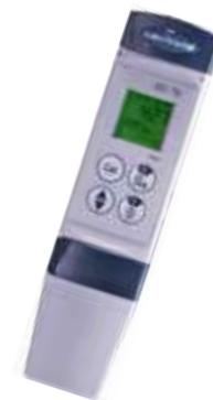
Mide la conductividad desde 0 hasta 1999 $\mu\text{s}$  con una precisión de +/- 1% y compensación automática de la temperatura. Pantalla amplia de cristal liquido. El diseño liviano permite operarlos con una mano.
