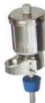
Equipo diseñado para facilitar el uso filtrar líquidos bajo vacío, recomendado para usar con manifold, capacidad del embudo graduado 300 ml, compatible con filtros de membranas de 47 mm, prefiltros de 41 mm área de filtración 13.5 cm<sup>2</sup> esta unidad es autoclavable con la membrana en su lugar.
