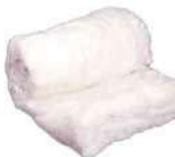
Es una fibra mineral con millones de filamentos de vidrio unidos con un aglutinante. El espacio libre con aire atrapado entre las fibras aumenta la resistencia a la trasmisión de calor.
