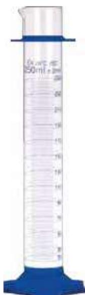
Construcción de dos piezas una parte superior fabricada en vidrio borosilicato de 3.3 con escala graduada y una base hexagonal moldeada en polipropileno que absorbe los impactos y reduce las roturas. Instrumento de laboratorio que se utiliza, sobre todo en análisis químico, para contener o medir volúmenes de líquidos de una forma aproximada.
