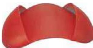
Para manejo de altas temperaturas. Protector para vasos, erlenmeyer, etc, ideal para sujetar objetos fríos o calientes. Superficie rugosa para facilitar el agarre.
