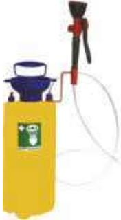
Fabricado en polietileno, equipado con reductores de presión. Capacidad para 5 Litros de solución salina, solo basta presionar la valvula de 50 a 90 veces para añadir aire y obtener un flujo continuo durante 15 minutos.
