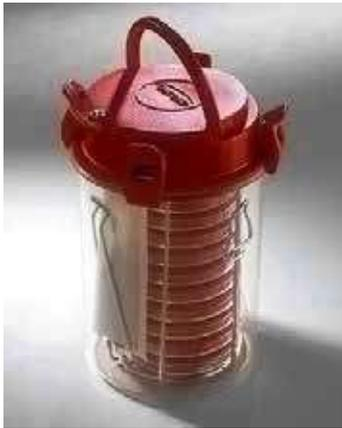
Jarra transparente diseñada en policarbonato para cultivo anaerobio con capacidad de 2,5 lt. La tapa de la jarra está diseñada en aluminio moldeado a presión; contiene una válvula de presión, una válvula de vacío, una válvula de seguridad y un manómetro de presión de vacío compuesto. Para aumentar la seguridad esta jarra está equipada con una abrazadera de tres dedos en aluminio para un sellado más hermético.
