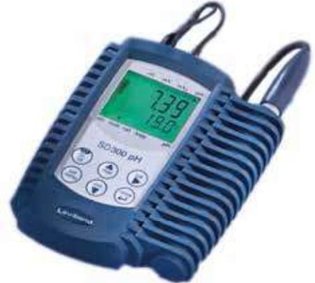
Es un modelo PORTÁTIL de pH / mV con 1 ó 2 puntos de calibración y reconocimiento automático con control manual. La unidad muestra simultáneamente la temperatura compensada de lecturas pH o potencial de electrodo y la temperatura. Electrodo de aplicación específica, memoria para 32 lecturas, 500 horas de duración de la batería. pantalla LCD retroiluminado.
