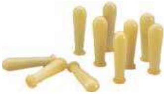
Fabricado en látex natural, facilita aspirar y dispensar los líquidos de las pipetas Pasteur de vidrio.
