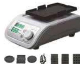
Control de velocidad variable. Operación continua, así como con arranque automático, Adjunto estándar para la prueba tubos de hasta 20 mm Ø
