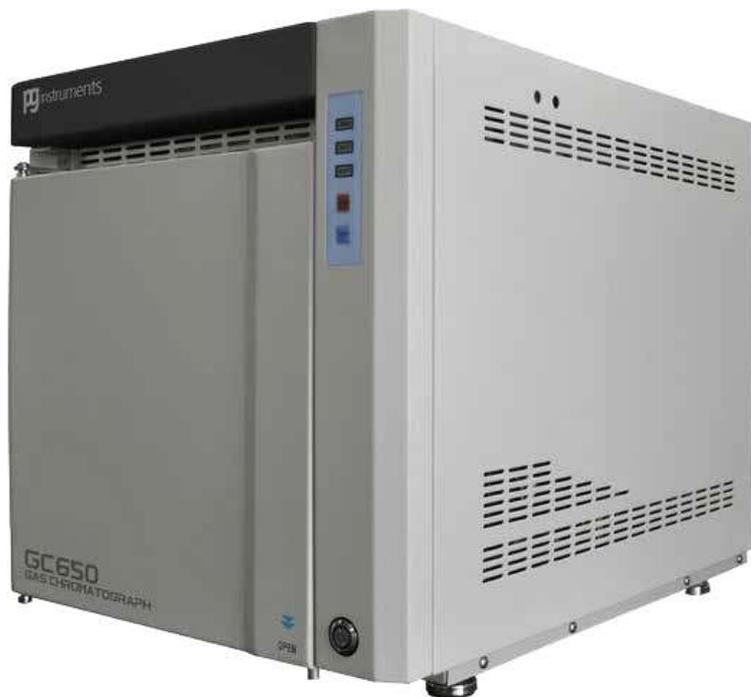
GC-650 Es la una solución de calidad superior, particularmente usado para el análisis de muestras ambientales (calidad del agua, aire, suelo y residuos) resultados satisfactorios que pueden ser logrados mediante la conexión entre preparación la de la muestra y el sistema. 3 señales de salida simultaneas, 4 canales de detección.
