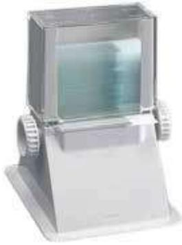
Estos dispensadores de diapositivas son adecuados para portaobjetos estándar 25 x 75 mm. El diseño general de los dispensadores hace que sea fácil de cargar y dispensar las laminas. Los usuarios pueden activar sin esfuerzo cada lado de la rueda para dispensar laminas de una en una. Adecuado para 72 PC de portaobjetos de microscopio
