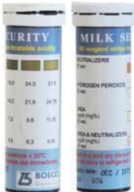
Se utilizan principalmente en la industria lechera para poner a prueba la pureza y calidad de la leche. Estas tiras de prueba proporcionan resultados precisos y son bastante fiables.
