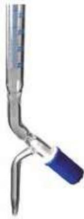
Bureta con Franja blanca posterior a la graduación (SCHELLBACH) para permitir una mejor visibilidad a la lectura. Fabricado en vidrio borosilicato de 3.3 **DIN/ISO385** con llave teflón (PTFE) politetrafluoroetileno, Estándares USP. Realiza valoraciones de forma rápida y con alta precisión.
