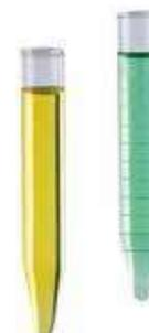
Fabricados en VIDRIO borosilicato 3.3 ACORDE A API/ASTM Utilizados en laboratorios para fiscalización de petróleo.
