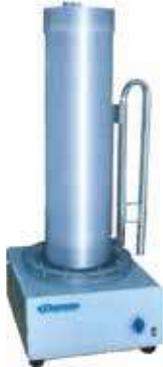
Para limpiar todo tipo de pipeta incluso si es de forma hueca. Puede remover suciedad con 10 veces más eficiencia que limpiar a mano. Usando detergente, las pipetas pueden limpiarse eficientemente y de manera segura. Con su ultrasonido, puede lavar cualquier diámetro de pipeta o tubo. Si se usa una canastilla para pipetas, varias pipetas pueden ser limpiadas a la vez. Gran potencia y durabilidad. Control de tiempo de limpieza (Max. 60 min).
