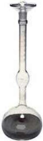
Fabricado en vidrio borosilicato 3.3. Normalmente usado para obtener la gravedad específica, trabajar en control de calidad del cemento, arena y materiales finos afines, etc.
