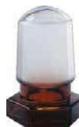
Fabricados en vidrio borosilicato de 3.3, tapon hueco esmerilado con cabeza hexagonal
