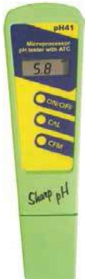
Cuenta con un sistema de conexiones que elimina errores de lectura de las salidas obstruidas. El microprocesador Sharp Tester proporciona al usuario; calibración y reconocimiento automático. Desconexión automática después de 10 minutos ahorrando la vida de la batería. Todos los probadores MARTINI son moldeados por inyección con una resistente carcasa a prueba de salpicaduras.
