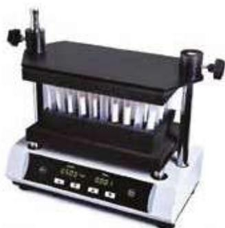
El mezclador VORTEX para múltiples tubos puede procesar 50 muestras a la vez. Una variedad de accesorios se pueden seleccionar para satisfacer las necesidades de mezcla de diferentes tubos de ensayo.
