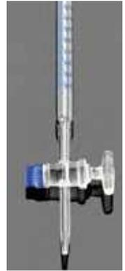
Fabricado en VIDRIO BOROSILICATO DE 3.3 con llave en vidrio. Realiza valoraciones de forma rápida y con una alta precisión.
