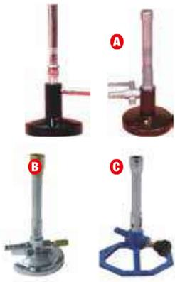
El mechero Bunsen es una de las fuentes de calor más sencillas del laboratorio y es utilizado para obtener temperaturas no muy elevadas. Consta de una entrada de gas sin regulador, una entrada de aire y un tubo de combustión. El tubo de combustión está atornillado a una base por donde entra el gas combustible a través de un tubo de goma, con una llave de paso. Presenta dos orificios para regular la entrada de aire.
