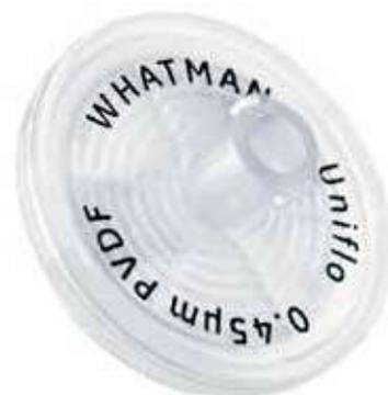
La construcción del filtro jeringa **DE 3 CAPAS** facilita la capacidad de carga excepcional con velocidades de flujo rápido. Esto evita la acumulación de presión de retorno típicamente causada por el bloqueo de una membrana sin protección.
